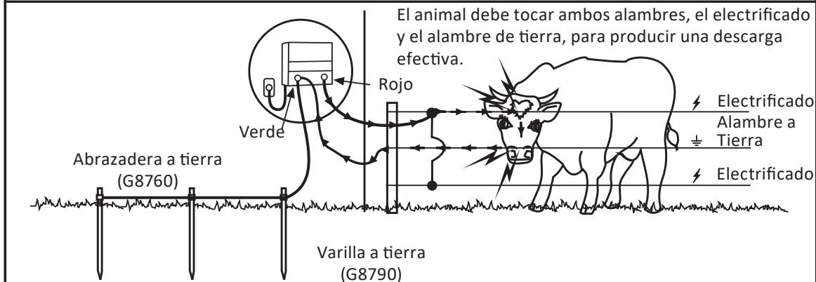
Las varillas de toma de tierra, de no menos de 2m (61/2 pies) de largo, deberán estar separadas a 3m (10pies) una de otra. Utilice un mínimo de 3 varillas de tierra.
