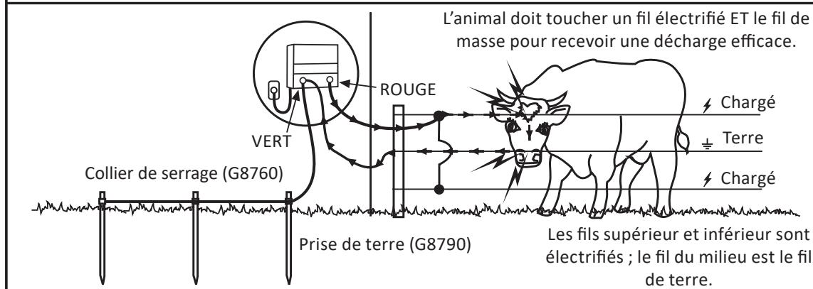
Des prises de terre, d'une longueur minimale de 2 mètres, doivent être enfoncées dans le sol avec un écartement d'au moins 3 mètres. Utilisez au minimum 3 tiges de terre.
