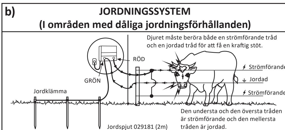
Minst en meter långa jordspjut bör fördelas med ett mellanrum på 3 meter. Använd ett minimum av 3 jordspjut.
