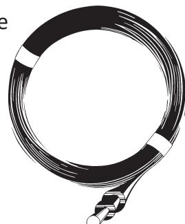
Wenn die Mitte des Zaunsystems weiter als 100 m vom Elektrozaungerät entfernt ist, ist zumindest 1 x 2,5 mm Draht nötig. Wenn die Mitte des Zaunsystems weiter als 1 km vom Elektrozaungerät entfernt ist, sind zumindest 3 x 2,5 mm Drähte nötig oder ein hochleitfähiger 2,5 mm „Powerdraht“. Größere Zaunsysteme oder schwer belastete Zaunsysteme mit starken Elektrozaungeräten können noch mehr Drähte benötigen, um die Energie hinreichend vom Elektrozaungerät zum Zaunsystem zu übertragen.
