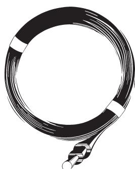
Se il centro della recinzione è a più di 100 m dall'elettrificatore, usare almeno un cavo da 2,5 mm di diametro. Se il centro del sistema di recinzione è a più di un km dall'apparecchio, è necessario usare almeno tre cavi da 2,5 mm o un singolo cavo ad altissima conducibilità "PowerWire". Grandi recinzioni soggette a forte crescita erbosa collegate ad elettrificatori potenti possono richiedere più fili per trasferire un'adeguata quantità di energia dall'apparecchio alla recinzione.
