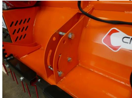
3. Montieren Sie als Nächstes die Hinterste M12-Schraube an der unteren Rückseite der Deichselhalterung, indem Sie die Deichsel nach oben führen, die Schraube einführen und die Unterlegscheiben und die Mutter locker anbringen.
