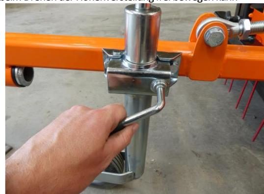
7. Zum Schluss montieren Sie das Stützrad, indem Sie die Klemme lösen, das Stützrad in die Klemme einsetzen und fest anziehen.
