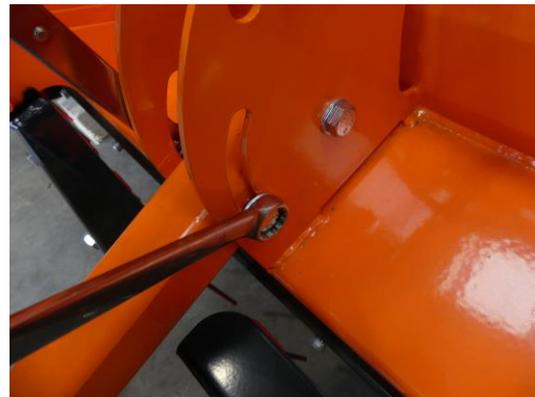
5. Stützen Sie das Gewicht der Deichsel und heben Sie sie an, bis der Deichselversteller mit der letzten M16-Schraube oben an der Deichselhalterung ausgerichtet ist. Auf beiden Seiten des Verstellers sollte sich eine Aluminium-Distanzbuchse befinden (nicht im Bild).
