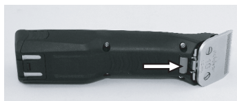
Fig. 7 Enclavamiento cabezal esquiladora
